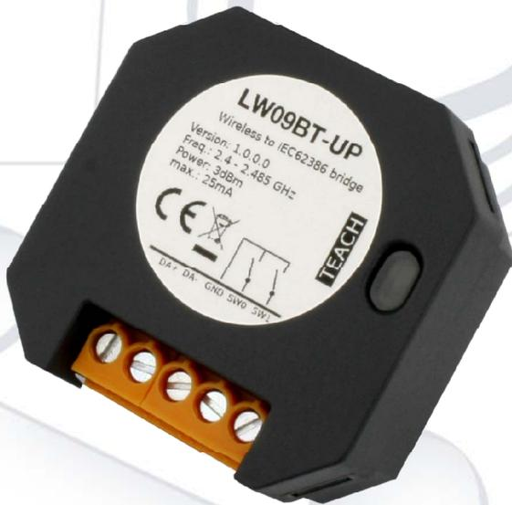
Der LED-Warrior09BT-UP kann Kommandos zur Lichtsteuerung an den IEC62386-Bus senden. Die Kommandos können über zwei Schaltereingänge oder per 2,4 GHz Funk (kompatibel mit BT 4.0LE) ausgelöst werden.
